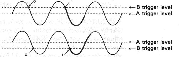
iii) A SLOPE: -, B SLOPE: +
